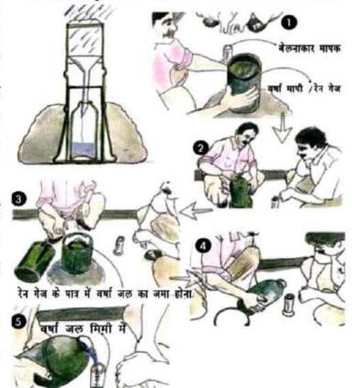
चित्र 24: मैनुअल रेन गेज का उपयोग कर वर्षा का मापन
