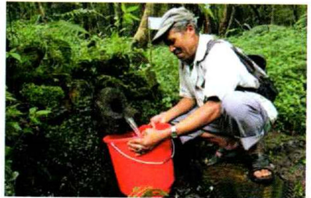
चित्र 25: बाल्टी और स्टॉपवाच का उपयोग कर जल उत्सर्जन की माप करना
