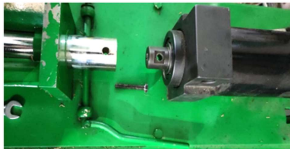
(चित्र14). हाइड्रोलिक से पिस्टन को अलग करने का सही तरीका
