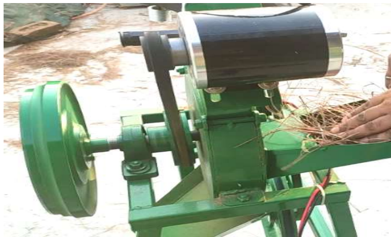
(चित्र).5 पेरुल को इनपुट करने हेतु हॉपर का उपयोग
